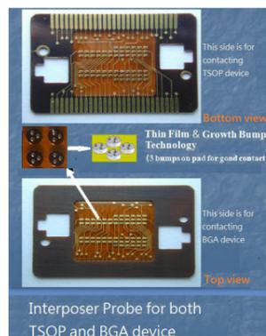
圖6 轉換薄膜探針用來轉換TSOP和BGA元件
