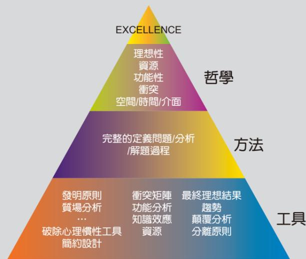
圖3 萃智階層式概觀(Hierarchical View of TRIZ)
